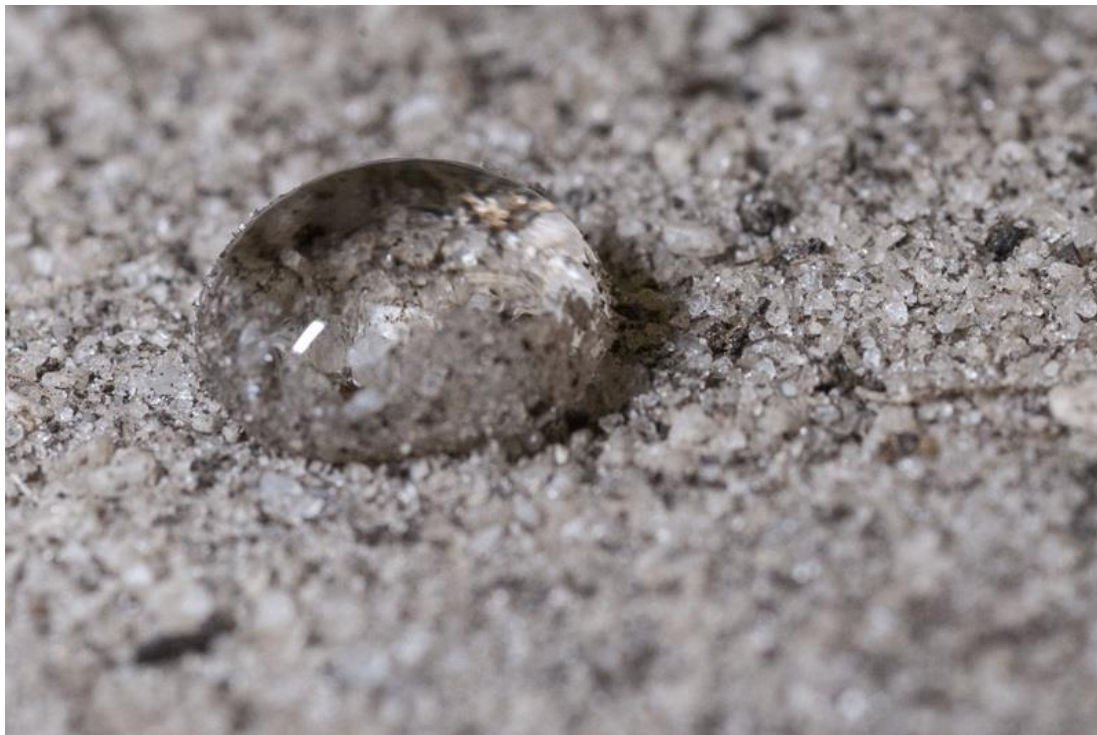
Figura 8. Pietra naturale trattata con idrorepellente. Fonte: CSIRO.
