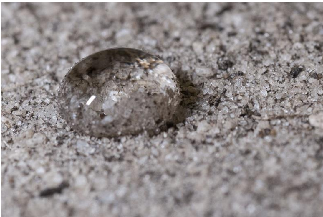
Εικόνα 8. Φυσική πέτρα επεξεργασμένη με υδατοαπωθητικό. Πηγή: CSIRO.
