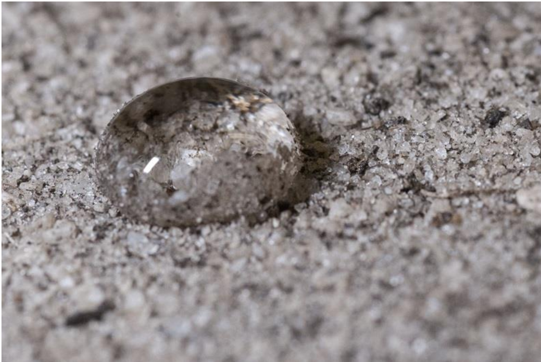
Abb 8. Mit wasserabweisendem Mittel behandelter Naturstein. Quelle: CSIRO.
